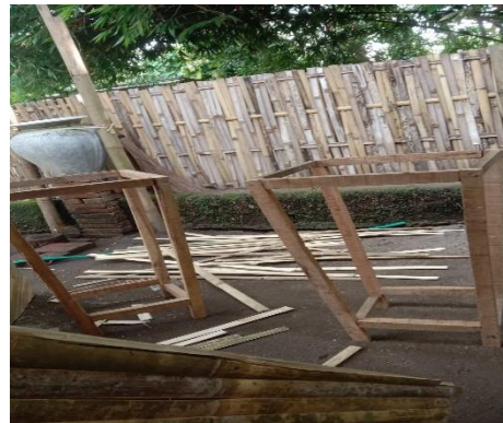
Gambar 1.3 Pembuatan kerangka bak sampah
