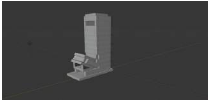
Gambar 1. Desain Alat Tempat Pembakaran Sampah Minim Asap
