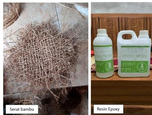
Gambar 1. Bahan penyusun komposit bambu-epoxy
