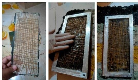
Gambar 2. Proses pembuatan komposit
