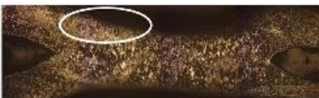
Gambar 9. Cacat *indented surfaces* spesimen SWAB A90 T10.
