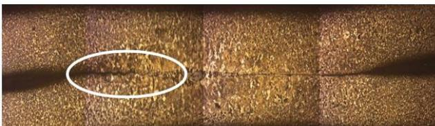
Gambar 8. Cacat *crack* spesimen SWAB A90 T02.
