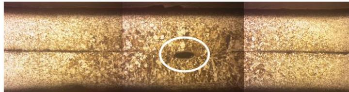
Gambar 10. Cacat *void* spesimen SWAB A05 T06.
