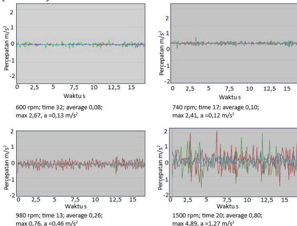
Gambar 4 Nilai percepatan getaran berdasarkan putaran motor.
