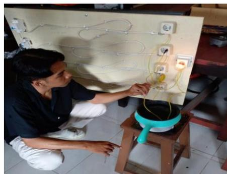
Gambar 3. Pengujian arus bocor oleh tim PKM pada modul pelatihan
