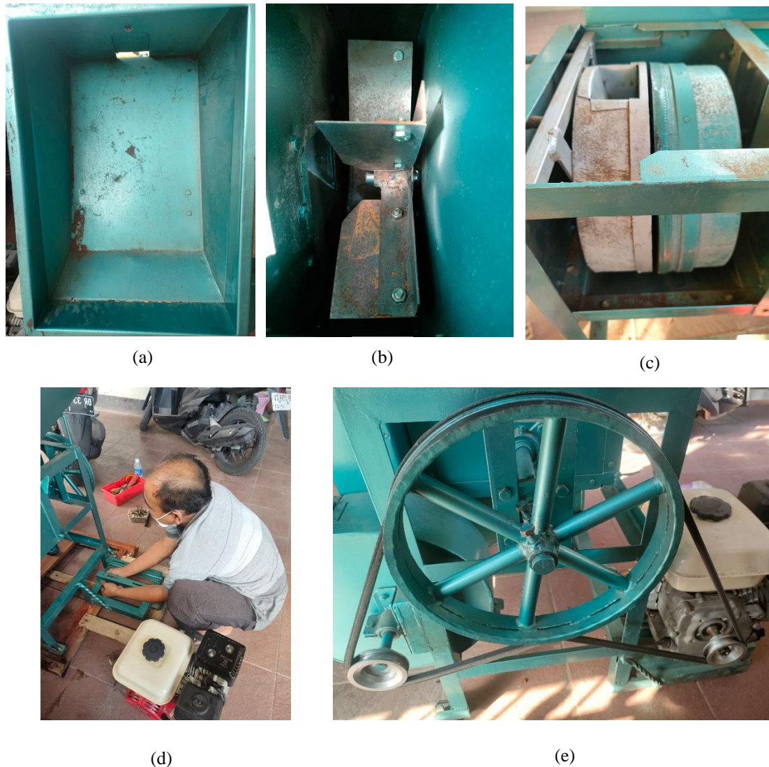
Gambar 3. Pengenalan dan cara perakitan mesin pengupas dengan pemasangan (a) hopper , (b) blower , (c) penggilas, (d) mesin penggerak, dan (e) system transmisi
